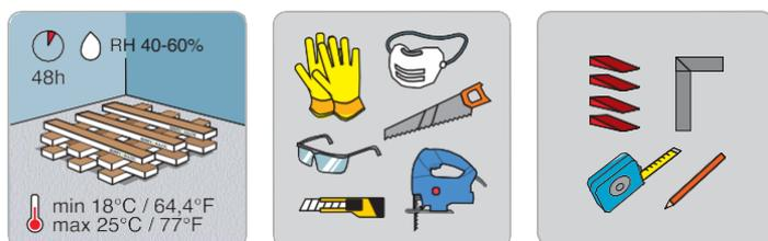
Il est important de stocker vos boîtes de stratifié à température ambiante au moins 48 heures avant l'installation. Ne pas ouvrir les boîtes, les empiler de manière à avoir un contact maximal avec l'air. Le sol doit être installé à une température ambiante de 18 à 22 ° C et un taux d'hygrométrie de 40 à 50%.
