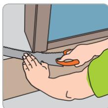
Les encadrements de porte en bois doivent être suffisamment raccourcis pour positionner en-dessous une lame et un support. Posez un panneau face vers le bas à côté de l'encadrement de porte. Coupez le panneau, puis glissez la lame sous l'encadrement de porte. Conservez un joint de dilatation de 8-10mm sous l'encadrement de porte !
