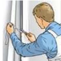
**5.** Découper le lé dans les coins et sur les bords et tapisser le lé suivant, bord à bord à joints vifs.
