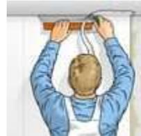
4. Enlever les excédents du plafond, des plinthes, des fenêtres etc. à l'aide d'une spatule en plastique et d'un cutter.
