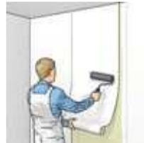
6. RENOMUR CLIMATEC doit être tapissé après le séchage. En tapissant, décaler les joints latéralement pour éviter un encollage bord à bord.
