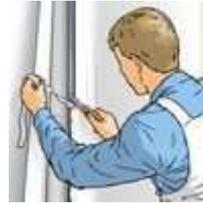
4. Dans les coins et sur les arêtes, découper le lé et tapisser le lé suivant bord à bord à joints vifs.
